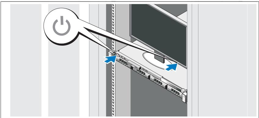
Presione el botón de encendido del sistema y del monitor opcional, si se utiliza. Los indicadores de alimentación deberían iluminarse.
