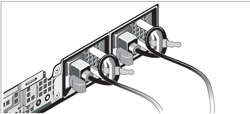
Zegnij kable zasilania systemu w pętlę, jak przedstawiono na rysunku, i zamocuj kabel na wsporniku, używając załączonej opaski. Następnie podłącz drugą końcówkę kabli zasilania do uziemionego gniazdka elektrycznego lub oddzielnego źródła zasilania, np. do zasilania bezprzerwowego (UPS) lub do jednostki rozdziału zasilania (PDU).
