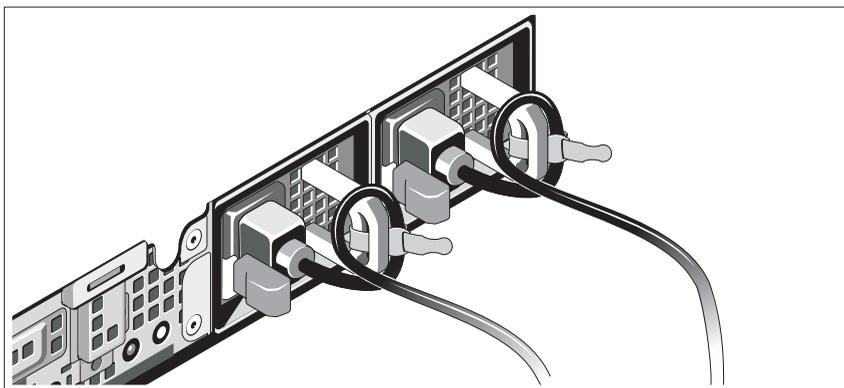
Ohněte napájecí kabely systému do smyčky, jak je znázorněno na obrázku, a připevněte je dodanou páskou k držákům. Poté zasuňte druhý konec napájecích kabelů do uzemněné elektrické zásuvky nebo je připojte k samostatnému zdroji napájení, například ke zdroji nepřerušitelného napájení (UPS) nebo jednotce rozvaděče (PDU).
