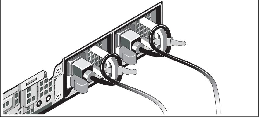
Sistemin güç kablolarını resimde gösterildiği gibi ilmek yapın ve kabloları sistemle birlikte verilen şeridi kullanarak desteklere sabitleyin. Güç kablosunun diğer ucunu topraklı bir elektrik prizine ya da kesintisiz güç kaynağı (UPS) veya güç dağıtım birimi (PDU) gibi ayrı bir güç kaynağına takın.
