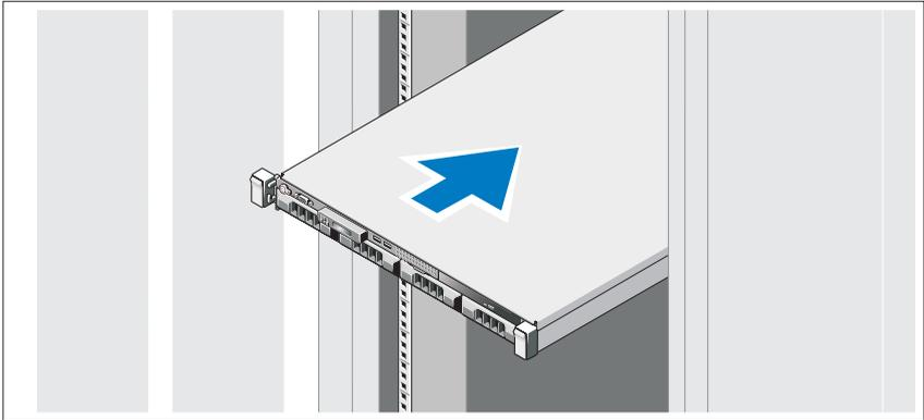
Συναρμολογήστε τις ράγες και εγκαταστήστε το σύστημα σε ράφι σύμφωνα με τις οδηγίες ασφάλειας και τις οδηγίες εγκατάστασης σε ράφι που παρέχονται με το σύστημά σας.
