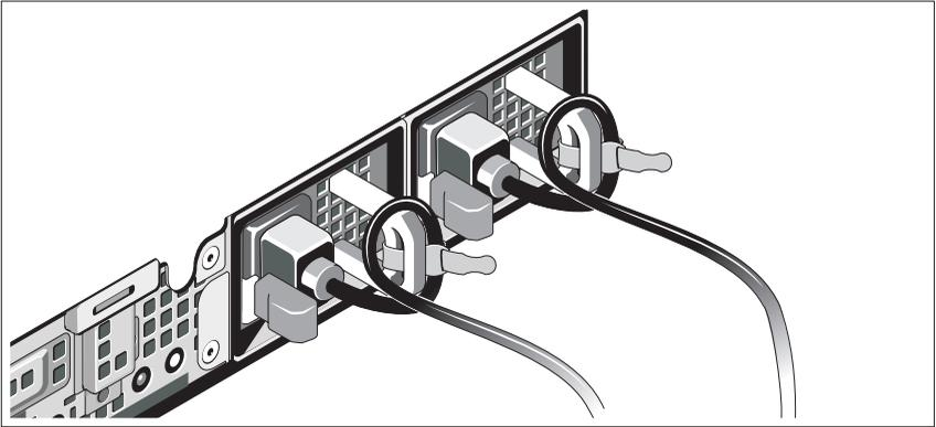
Κάμψτε τα καλώδια τροφοδοσίας του συστήματος σε μορφή βρόχου, όπως φαίνεται στο σχήμα, και χρησιμοποιήστε το συνοδευτικό λουρί για να στερεώσετε το καλώδιο στα στηρίγματα. Βυσματώστε το άλλο άκρο των καλωδίων τροφοδοσίας σε μια γειωμένη πρίζα ή ξεχωριστή πηγή ρεύματος, όπως π.χ. συσκευή αδιάλειπτης παροχής ρεύματος (UPS) ή μονάδα διανομής ρεύματος (PDU).
