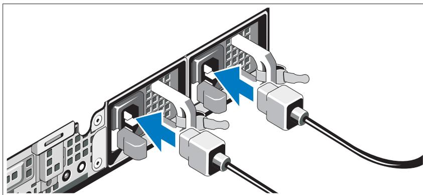
Podłącz odpowiedni kabel (lub kable) zasilania do systemu oraz do monitora, o ile używasz monitora.
