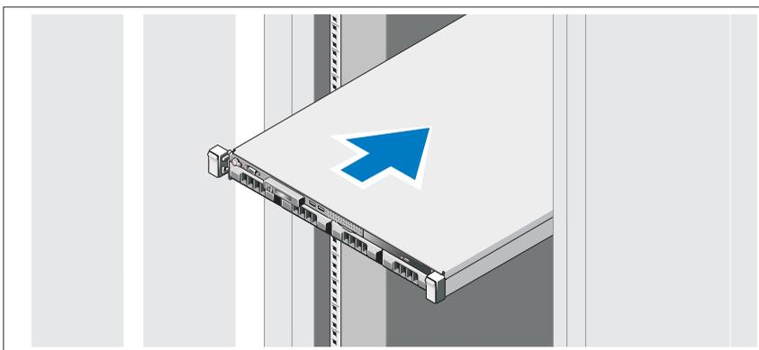
Sestavte kolejničky a nainstalujte systém do stojanu podle bezpečnostních pokynů a pokynů k instalaci do stojanu dodaných se systémem.
