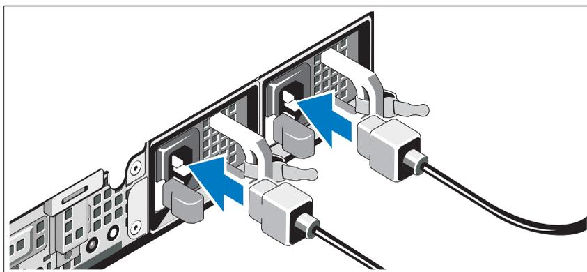
Подключите электрический кабель (кабели) к системе. Если используется монитор, также подключите к нему электрический кабель монитора.
