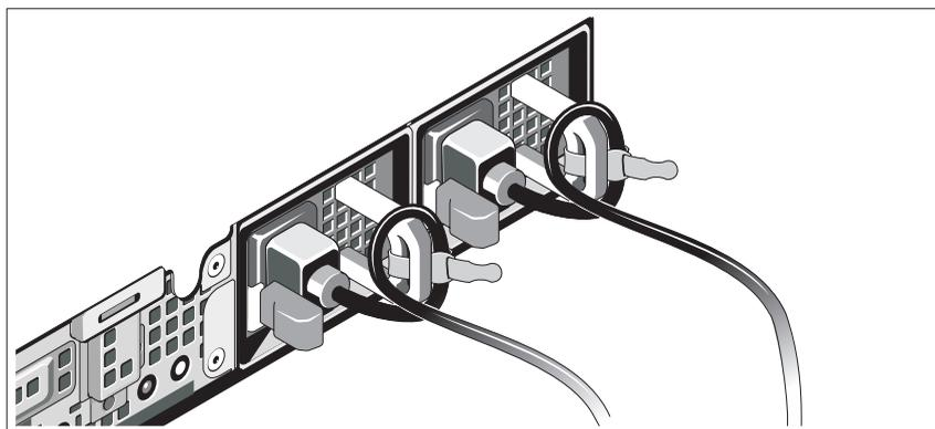
כופף את כבלי החשמל של המערכת וצור מהם לולאות כמוצג באיור. לאחר מכן חבר את הכבלים לתושבות באמצעות הרצועה שסופקה. חבר את הקצה השני של כבלי החשמל לשקע חשמלי מוארק או למקור מתח אחר, כגון מערכת אל-פסק (UPS) או יחידת חלוקת מתח (PDU).
