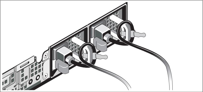
Faites une boucle avec chaque câble (voir l'illustration), puis fixez-le à l'aide de l'armature prévue à cet effet. Branchez ensuite l'autre extrémité de chaque câble d'alimentation sur une prise secteur mise à la terre ou sur une source d'alimentation autonome (onduleur ou unité de distribution de l'alimentation).
