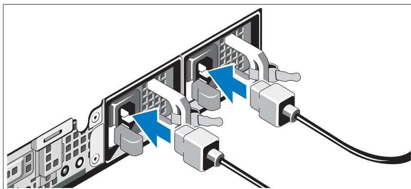
Συνδέστε το καλώδιο (ή τα καλώδια) τροφοδοσίας του συστήματος στο σύστημα και, εάν χρησιμοποιείτε οθόνη, συνδέστε το καλώδιο τροφοδοσίας της οθόνης στην οθόνη.
