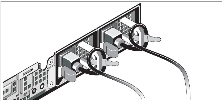
Изогните кабель питания системы в форме петли, как показано на рисунке, и прикрепите его шиной к прилагаемому ремню. Подключите другой конец шнура(ов) питания к заземленной розетке или отдельному источнику питания, например источнику бесперебойного питания или блоку распределения питания.
