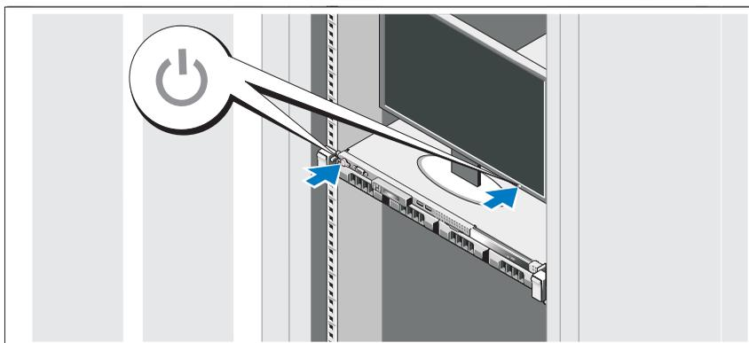
Stiskněte tlačítko napájení na systému a na monitoru (pokud je používán). Indikátory napájení by se měly rozsvítit.
