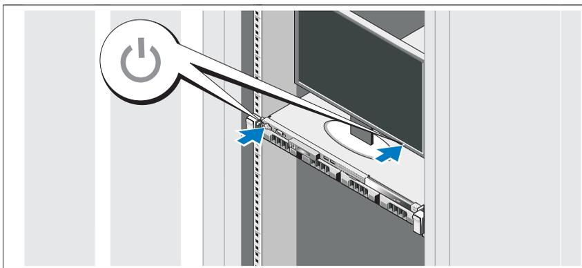
Нажмите кнопку питания на системном блоке и на дополнительном мониторе (если используется). Должны загореться индикаторы включения.
