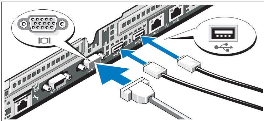
Подключите клавиатуру, мышь и монитор (дополнительно).
